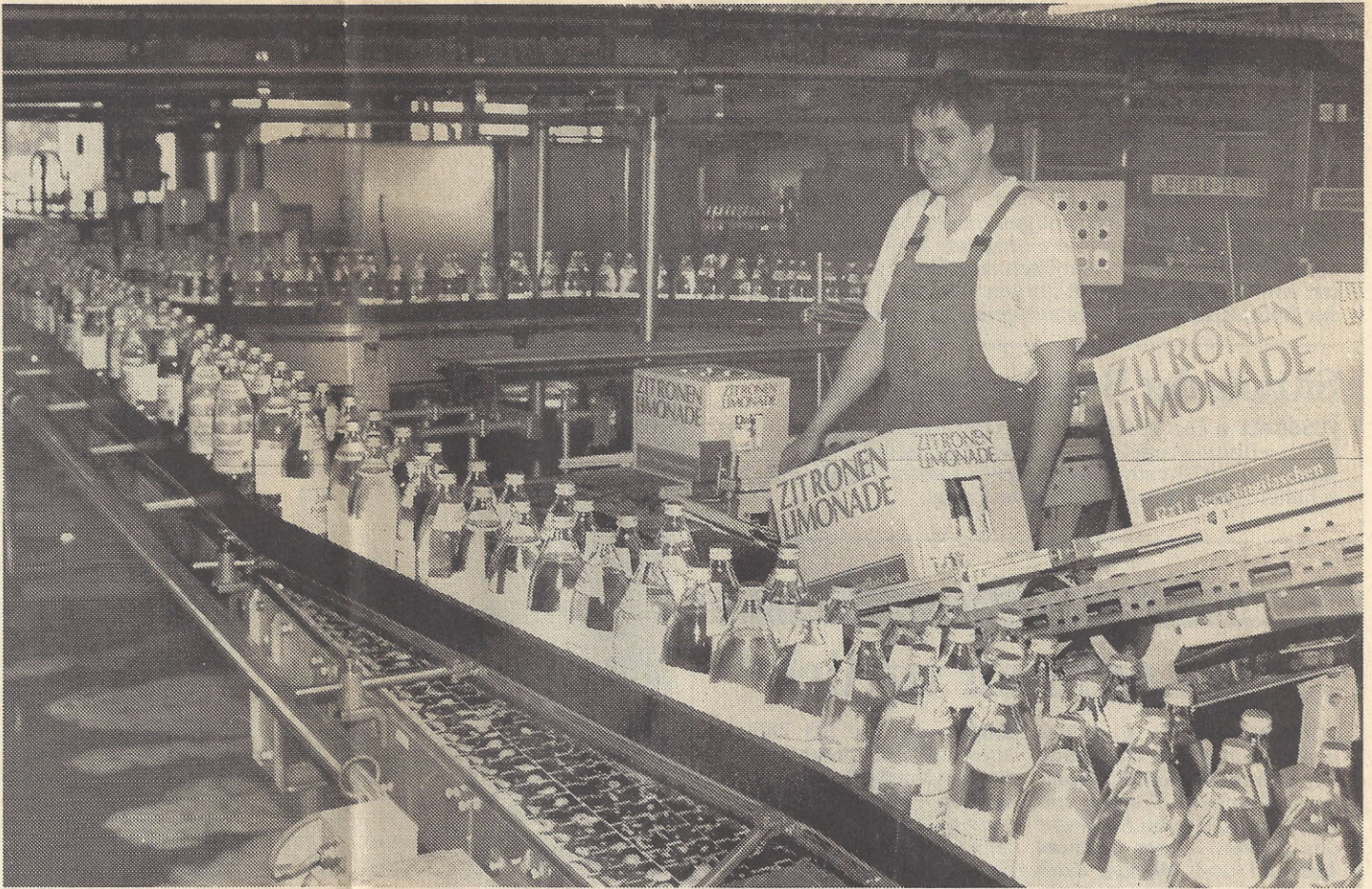
Auf zwei hochmodernen Abfüllanlagen werden in Beiseförth rund 200 Millionen Einweg-Flaschen jährlich mit Mineralwasser und Limonade gefüllt. 1,2 Millionen Hektoliter sprudeln jährlich aus den drei Quellen am Fuldaufer, die in Tiefen zwischen 40 und 120 Metern angezapft wurden. (Fotos:Stier)
