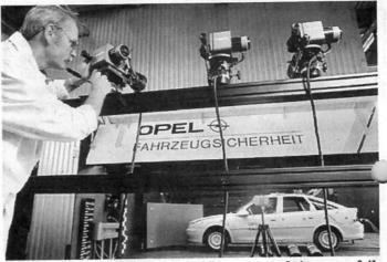
(wnp). Hochmoderne High-Speed-Kameras und eine ausgefeilte Meßtechnik werden eingesetzt, um so viele Daten wie möglich in einem Crashtest zu sammeln. Nach der Datenauswertung läßt sich dann die passive Sicherheit im Auto auf ein Höchstmaß bringen.
