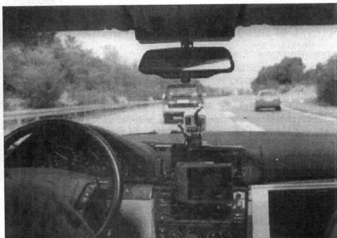
*Ips/ad. Ergibt sich eine Geschwindigkeitsdifferenz zum Vordermann, sorgt die Elektronik automatisch für sicheren Abstand.*
