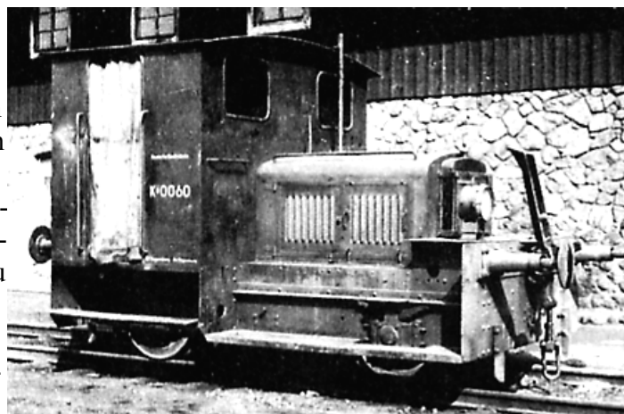
Eine Kleinlok der Bauart Kö I, gebaut ab 1933 (Aus: "Diesellokomotiven")
