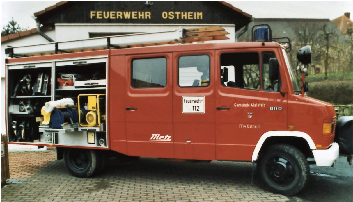
LF 8 mit Zusatzbeladung für technische Hilfeleistung
